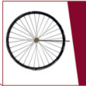
Fahrradreifen aus Draht Gummi war knapp. Hier ersetzt ihn eine Drahtspirale.
